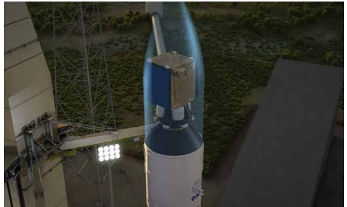
Die Kick-Stage Main Structure für die Trägerrakete Ariane 6: Entwickelt und gefertigt von FACC, muss das Carbonbauteil höchsten Belastungen standhalten.
